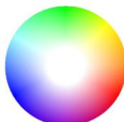
Wenn Sie die Mitte der weißen Fläche berühren, wird der MBNLED TOUCHCONTROL RGB DMX reinweißes Licht darstellen. Wenn Sie den Finger dann in Richtung Rot bewegen, wird sich das Licht zu einer rotweißen Farbe ändern. Auf diese Weise können Sie die Farbkalibrierung des weißen Lichtes genau einstellen.
